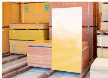
コンクリート型枠用合板
